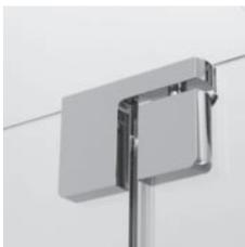
Der Hebe-/Senkmechanismus hebt die Türen beim Öffnen automatisch um einige Millimeter an. So gleiten sie auch bei bodenbündigem Einbau sanft über die Fliesen und senken sich beim Schließen wieder automatisch ab.
